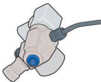
robinet d'arrêt au pied de la vanne.
