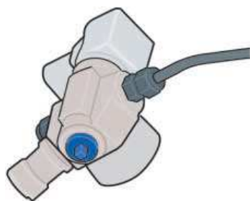
Rubinetto di chiusura manuale su piede della valvola della bombola
