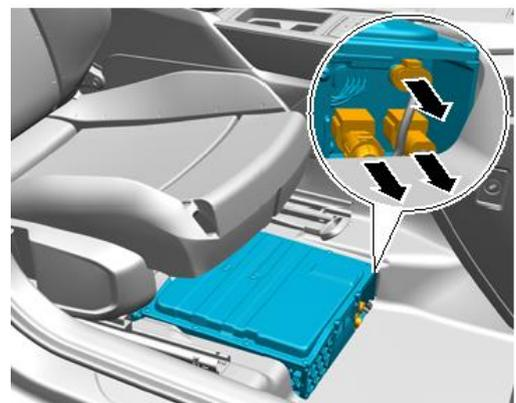
En los accidentes con despliegue de airbag, el sistema eléctrico del vehículo de 48 voltios se desactiva automáticamente.
